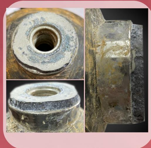
**SCHADENSSTUFE 3:** Ein als Level 3 eingestuft Schaden ist so schwerwiegend, dass der Zylinder nicht repariert werden kann: Er muss aussortiert und anschließend unbrauchbar gemacht werden.
