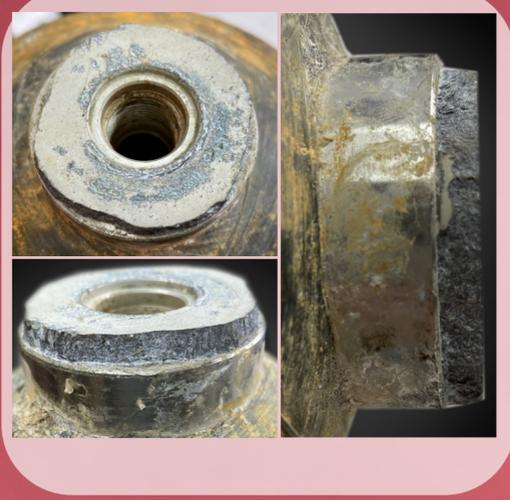
**NIVEL DE DAÑOS 3:** El daño de nivel 3 es lo suficientemente grave como para que el cilindro no pueda ser reparado: será rechazado y, posteriormente, ya no servirá.
