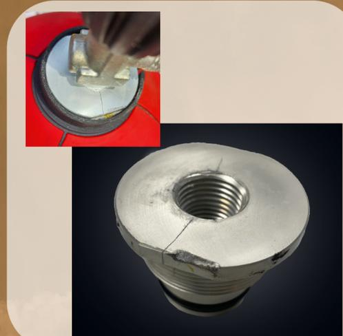
**DANNI LIVELLO 2:** Il danno di livello 2 può essere soggetto a rifiuto dopo il test. Questo tipo di danno viene dimostrato accettabile (Livello 1) dai test e dai risultati delle indagini di CTS S.p.A., oppure valutato come danno di Livello 3.
