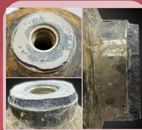
**DANNI LIVELLO 3:** Il danno di livello 3 è sufficientemente grave da rendere la bombola non riparabile: dovrà essere rifiutata e successivamente resa inservibile.
