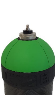
Abb. 4: Zylinder mit kleinem Ventil und 2 bar Innendruck
