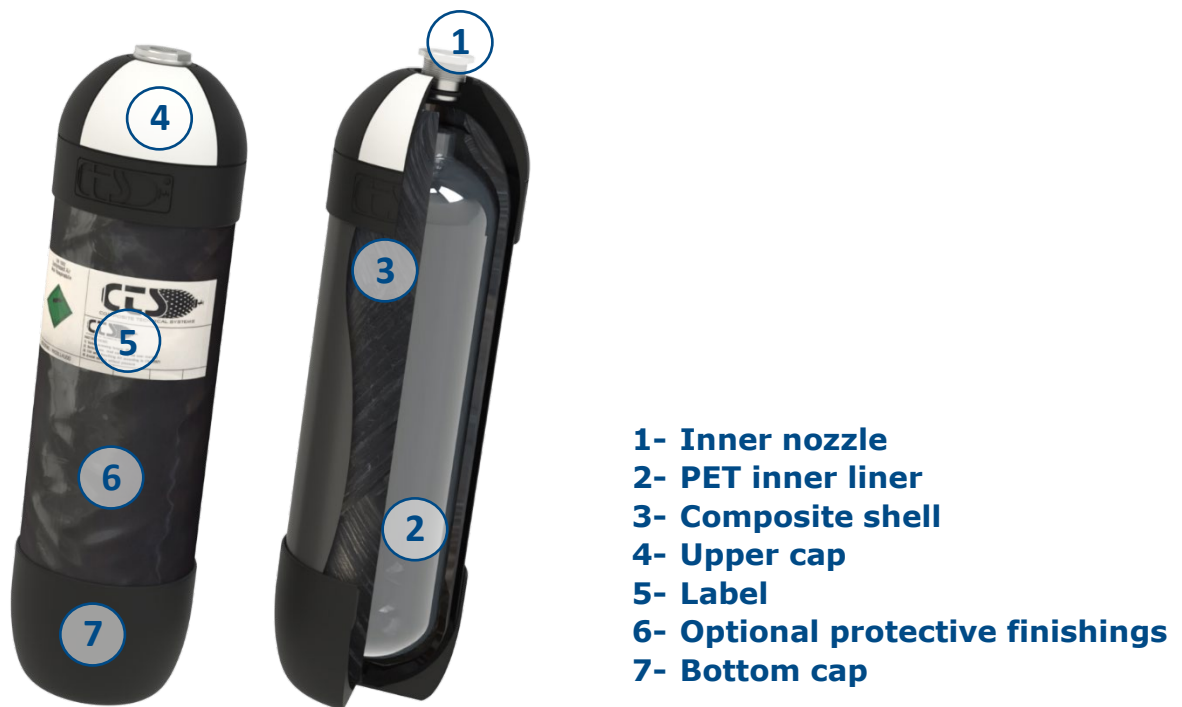
Figura 1. Esquema de composición del cilindro CTS
