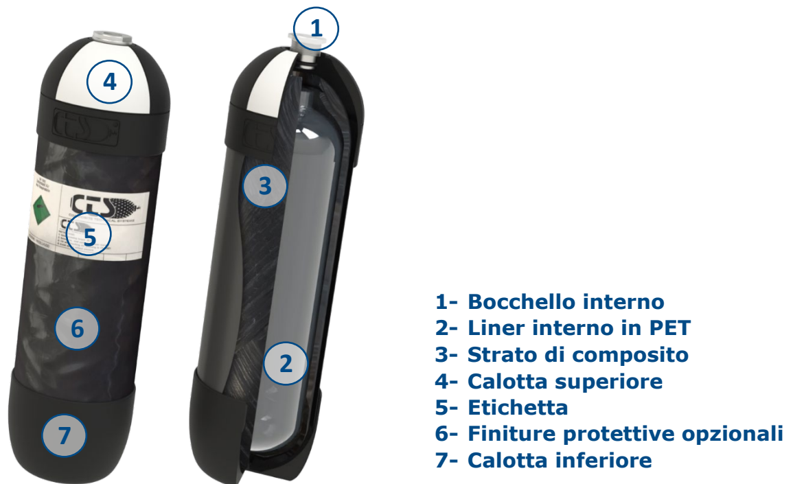
Figura 1. Schema composizione bombola CTS
