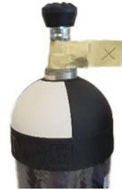
Abb. 7: Zylinder mit offenem Ventil und Manipulationssicherungsband
