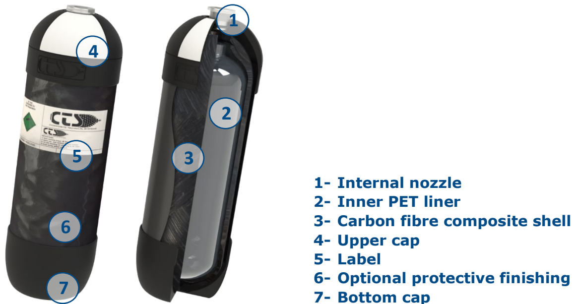
Figura 1. Esquema de composición del cilindro CTS
