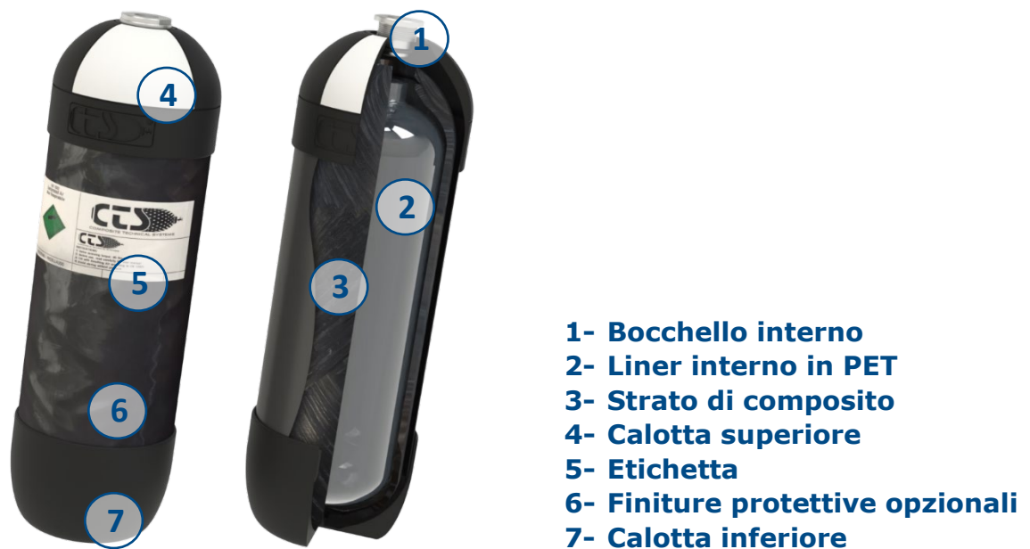
Figura 1. Schema composizione bombola CTS
