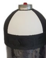
Afb. 6: Cilinder met dop en geen interne druk
