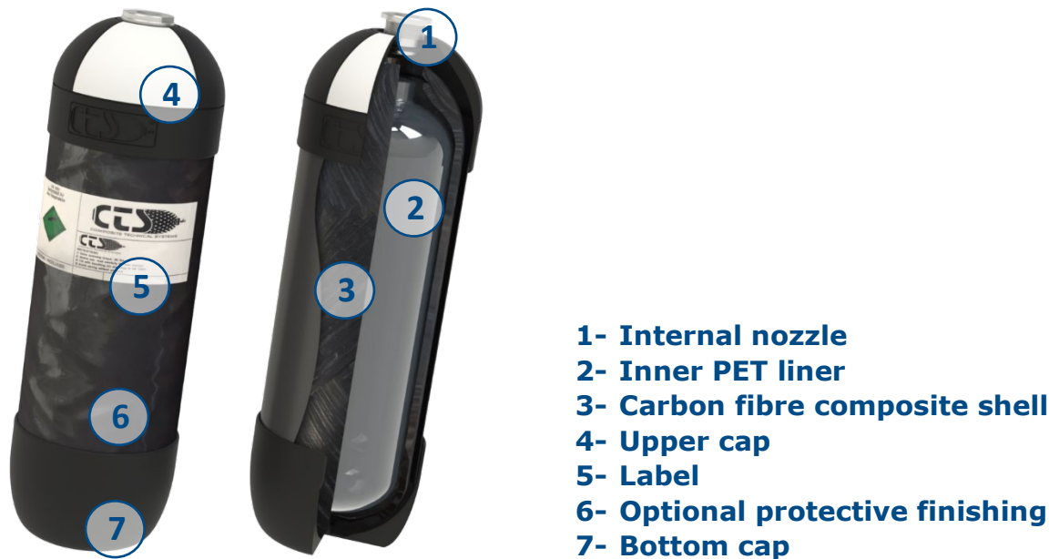
Afbeelding 1. Samenstelling van de cilinders van CTS
