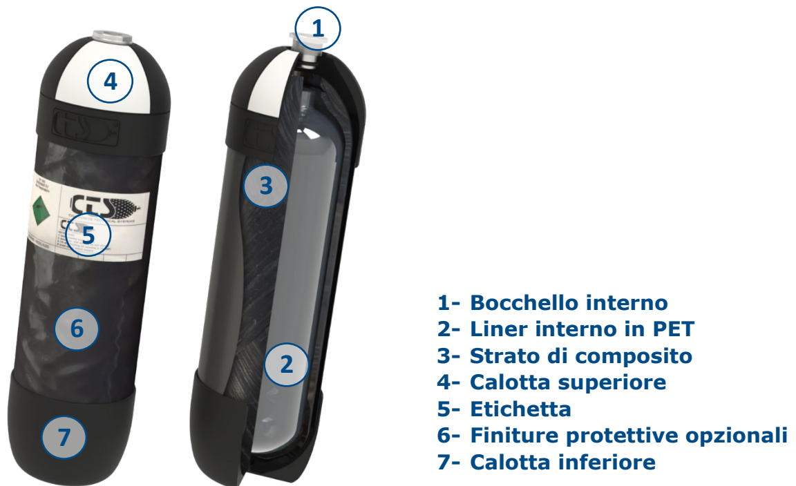
Figura 1. Schema composizione bombola CTS
