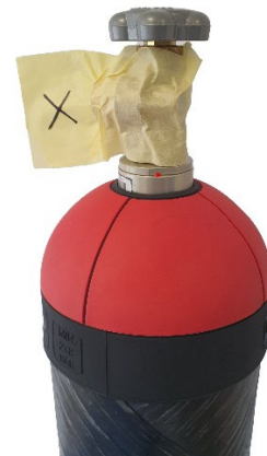
Fig.7: Bombola con valvola aperta e nastro anti-manomissione
