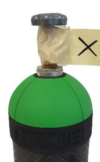
Fig.7: Bombola con valvola aperta e nastro anti-manomissione
