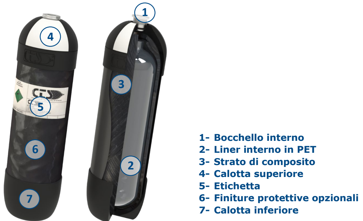
Figura 1. Schema composizione bombola CTS
