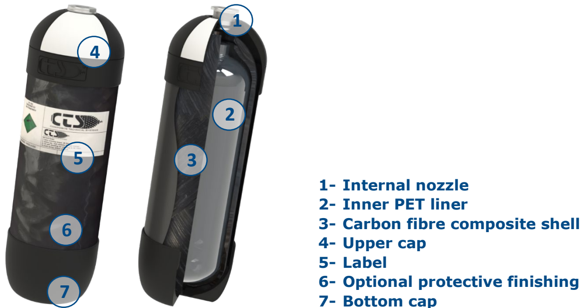
Abbildung 1. Diagramm der CTS-Zylinderzusammensetzung
