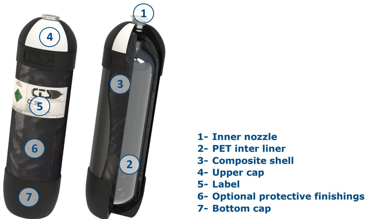
Abbildung 1. Diagramm der CTS-Zylinderzusammensetzung
