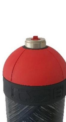
Abb. 6: Flasche mit Deckel und ohne Innendruck
