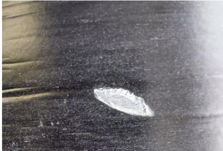
Die Delaminierung (siehe untenstehende Abbildung) darf nicht mit eingeschlossenen Lufteinschlüssen verwechselt werden, die das Ergebnis von Lufteinschlüssen während des Produktionsprozesses sind und sich insbesondere rund um das Etikett entwickeln. Eingeschlossene Lufteinschlüsse sind nicht problematisch.
