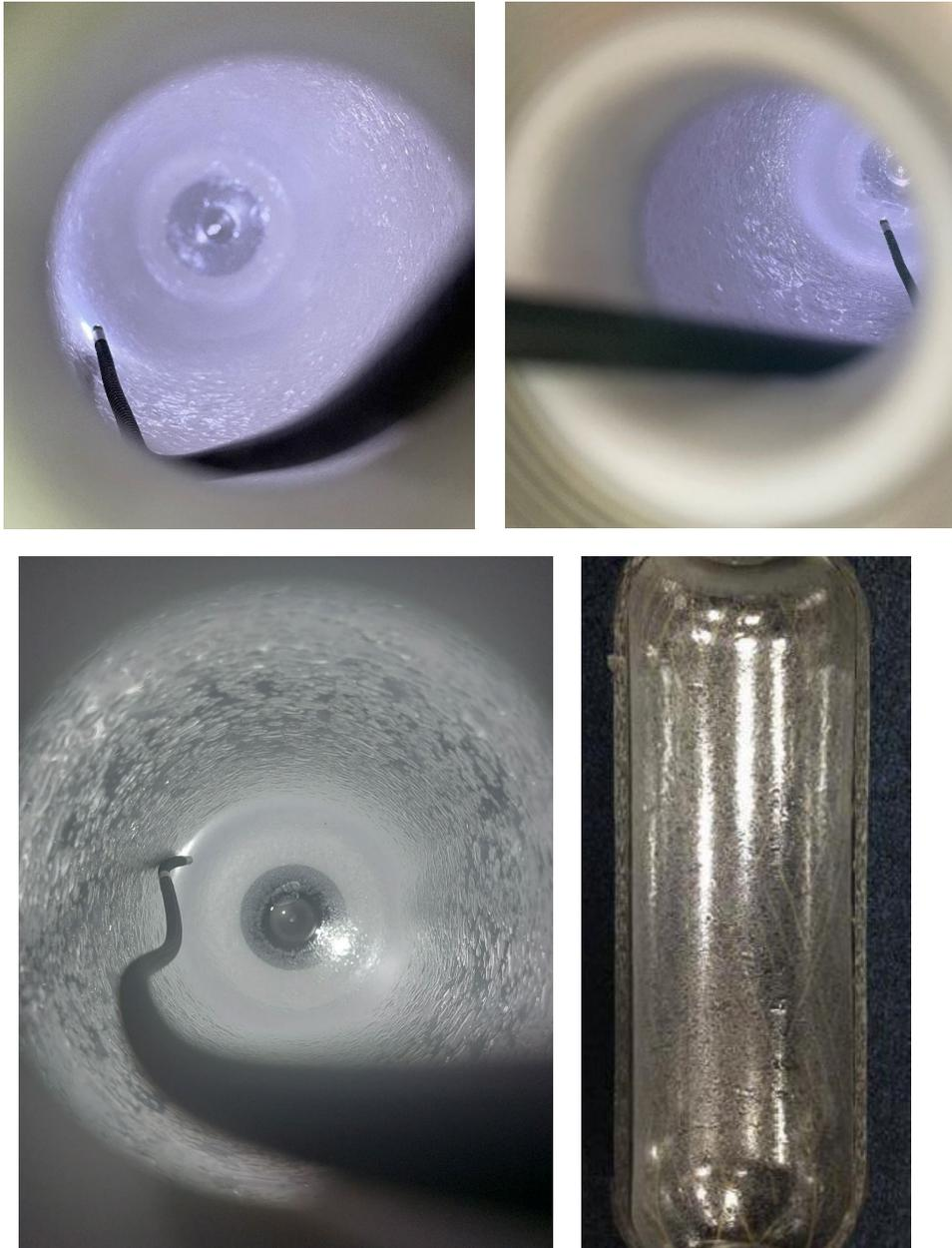
CTS S.p.A. reitera que los fenómenos de macro y micro blistering son fenómenos puramente estéticos y, en ningún caso, afectan o comprometen la seguridad, la estanqueidad y la correcta funcionalidad del cilindro. La única función del revestimiento interno de plástico es ser impermeable a los gases. Todas las propiedades mecánicas del cilindro corresponden a la carcasa exterior de material compuesto.
