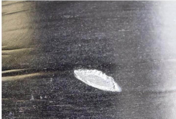
La delaminación (ver imagen a continuación) no debe confundirse con inclusiones de aire atrapadas, que son el resultado de inclusiones de aire durante el proceso de fabricación y se desarrollan principalmente alrededor de la etiqueta. Las inclusiones de aire atrapadas no representan un problema.
