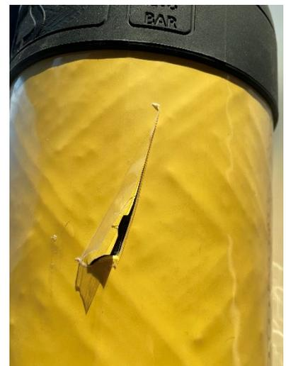
En caso de daños de nivel 2 en cilindros con acabado de protección de fibra de vidrio, los daños son de tal magnitud que la capa de pintura se ha eliminado por completo y la capa de material compuesto de fibra de vidrio se ha visto dañada. El usuario debe asegurarse de que los daños no hayan afectado al refuerzo de material compuesto de fibra de carbono situado debajo.
