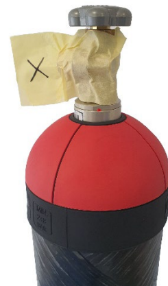
Fig.7: Bouteille avec vanne ouverte et ruban anti-effraction
