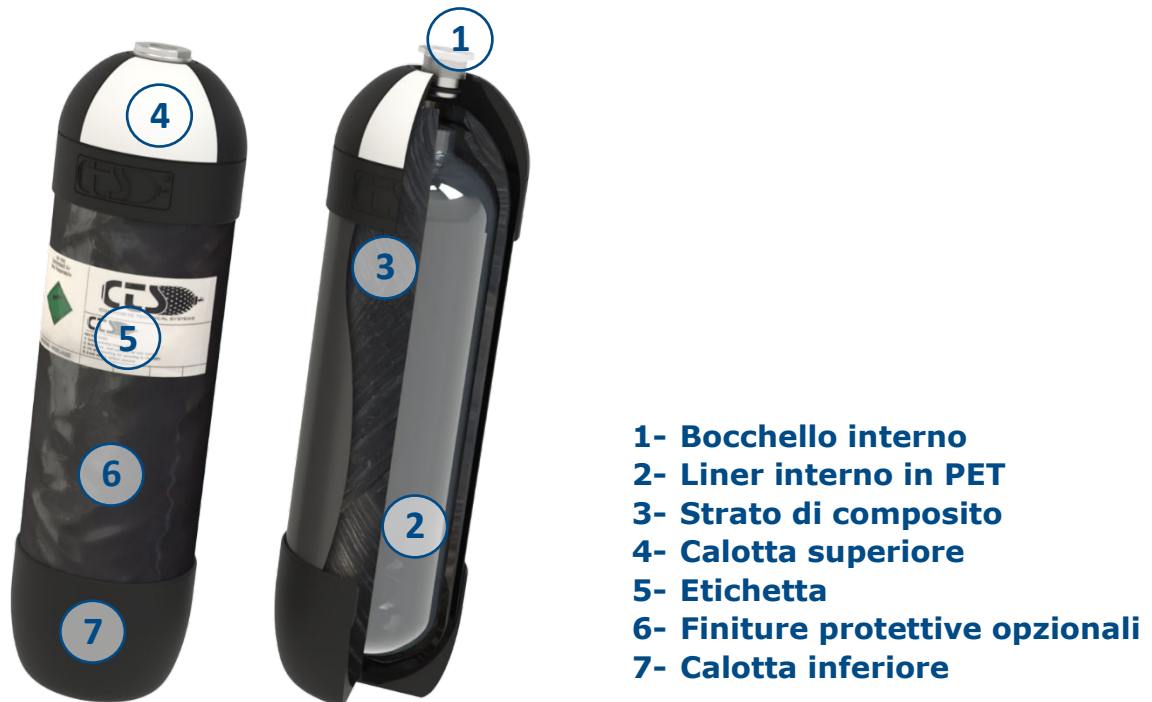
Figura 1. Schema composizione bombola CTS
