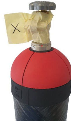
Fig.7: Bombola con valvola aperta e nastro anti-manomissione
