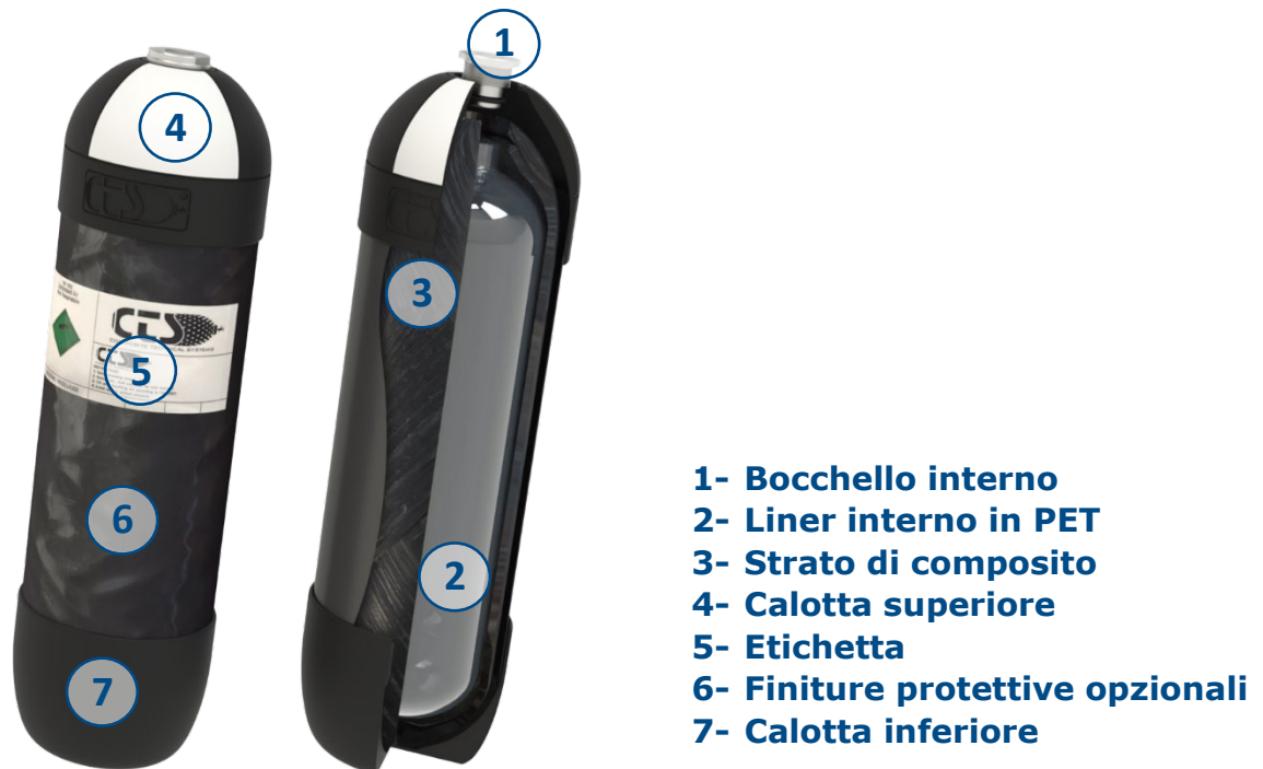
Figura 1. Schema composizione bombola CTS
