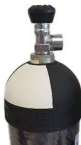
Sl. 5: Jeklenka z ventilom in notranjim tlakom 2 bara
