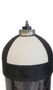
Sl. 4: Jeklenka z ventilom in notranjim tlakom 2 bara
