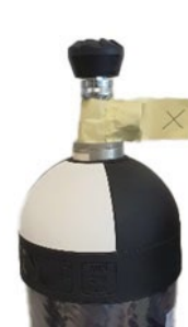
Sl. 7: Jeklenka z odprtim ventilom in trakom za zaščito pred odpiranjem
