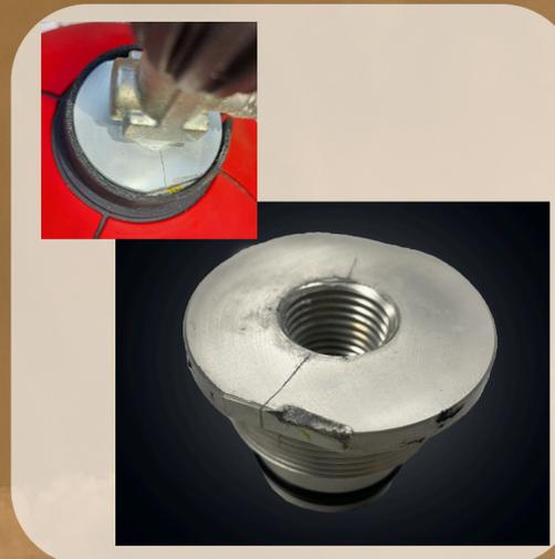
**SCHADENSSTUFE 2:** Wird ein Schaden als Level 2 eingestuft, kann der Zylinder nach dem Testen aussortiert werden. Diese Art von Schaden erweist sich gemäß den Ergebnissen der Tests und Untersuchungen durch CTS S.p.A. entweder als akzeptabel (Level 1) oder wird als Level 3 eingestuft.
