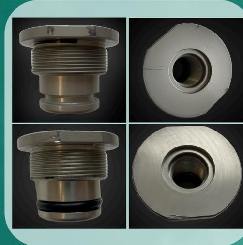
**SCHADENSSTUFE 1:** Diese Art von Schäden an Zylindern wird als Level 1 eingestuft und gilt als akzeptabel, also ist keine Reparatur erforderlich. Solche Schäden haben keine negativen Auswirkungen auf die Sicherheit des Zylinders und seine weitere Verwendung.
