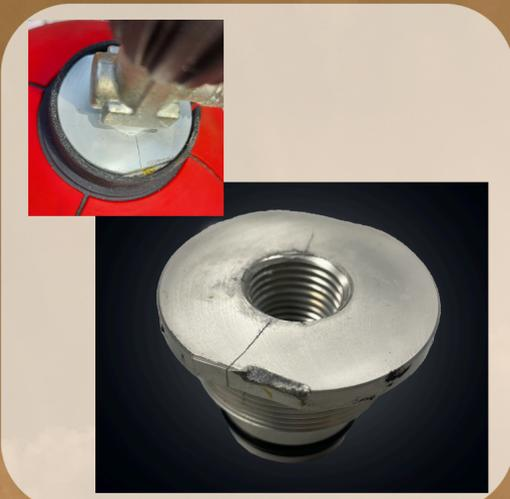
**NIVEL DE DAÑOS 2:** El daño de nivel 2 puede estar sujeto a rechazo después de la prueba. Este tipo de daño se ha demostrado que es aceptable (Nivel 1) por las pruebas de CTS S.p.A. y los resultados de la investigación, o bien se ha evaluado que es un daño de Nivel 3.
