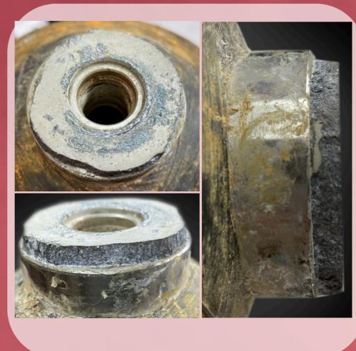
**DÉGÂTS NIVEAU 3 :** Les dommages de niveau 3 sont suffisamment graves pour que le cylindre ne puisse pas être réparé : il doit être rejeté puis rendu inutilisable.
