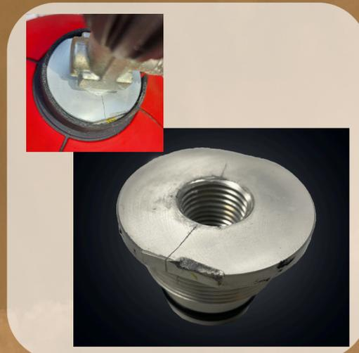
**DÉGÂTS NIVEAU 2 :** Les dommages de Niveau 2 peuvent être soumis à un rejet après les tests. Ce type de dommage est soit jugé acceptable (Niveau 1) à travers les tests de CTS S.p.A. et les résultats d'enquête, soit évalué comme un dommage de Niveau 3.
