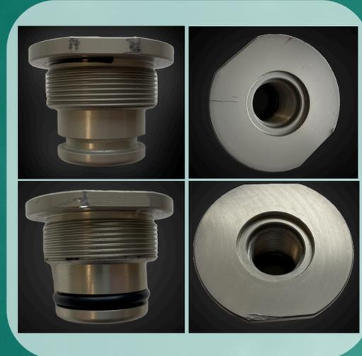
**DÉGÂTS NIVEAU 1 :** Ce type de dommages sur les cylindres est classé comme un dommage de niveau 1 et est acceptable, aucune réparation n'est donc nécessaire. De tels dommages n'ont aucun effet négatif sur la sécurité du cylindre et son utilisation continue.
