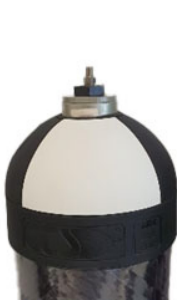
Fig.4: Cilindro con válvula y presión interna 2 bar
