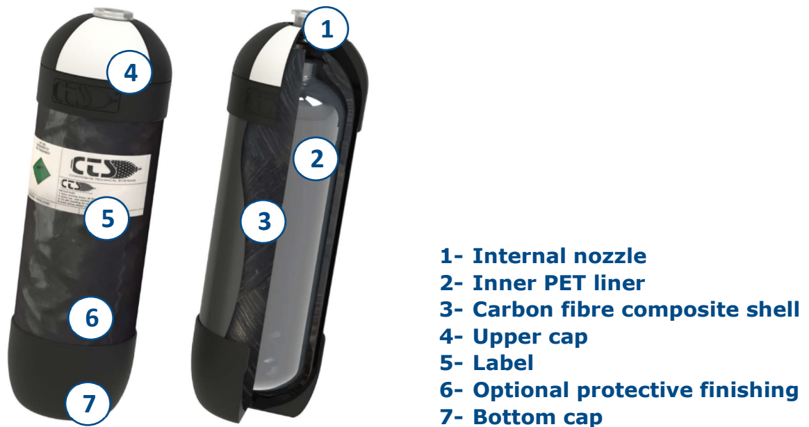
Figura 1. Esquema de composición del cilindro CTS
