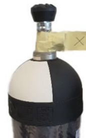
7. ábra: Palack nyitott szeleppel és biztonsági szalaggal
