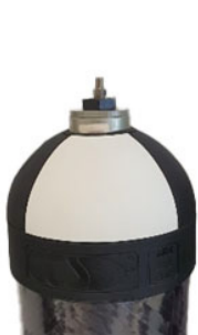
4. ábra: Palack kis szeleppel és 2 bar belső nyomással
