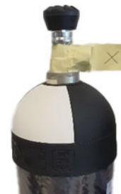
Fig.7: Bombola con valvola aperta e nastro anti-manomissione
