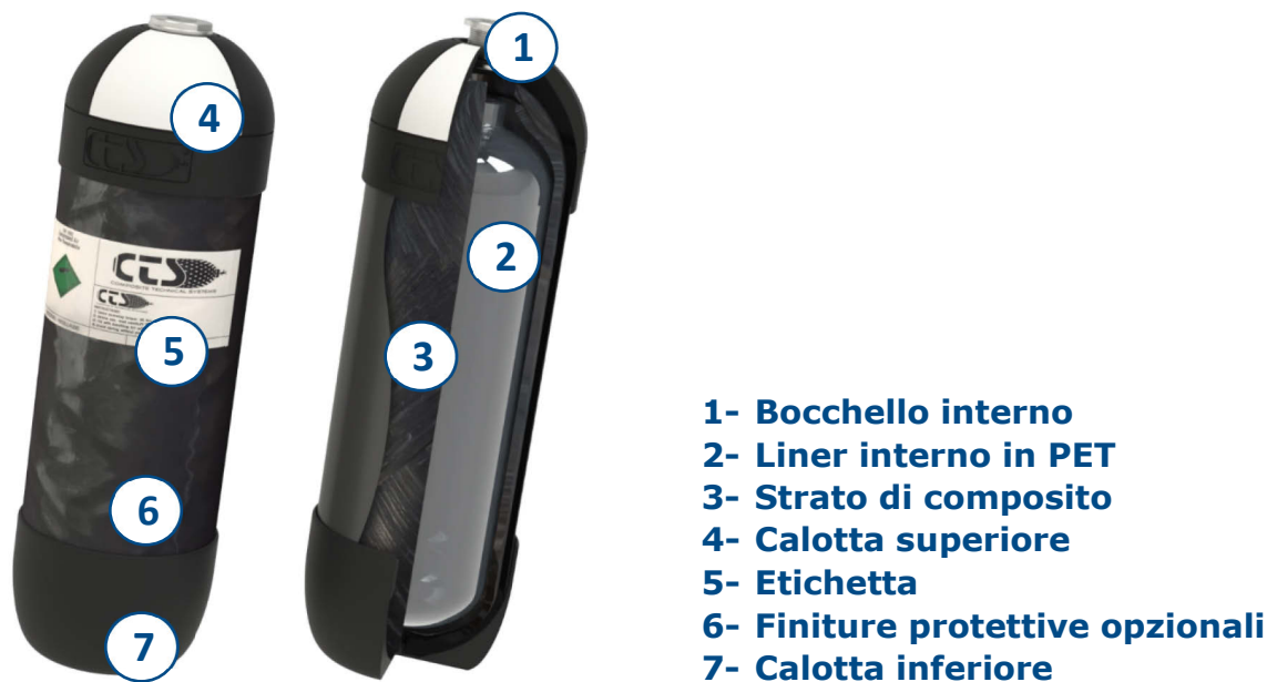
Figura 1. Schema composizione bombola CTS
