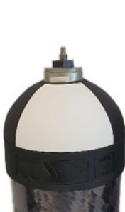
Fig.4: Bombola con valvolino e pressione interna 2 bar
