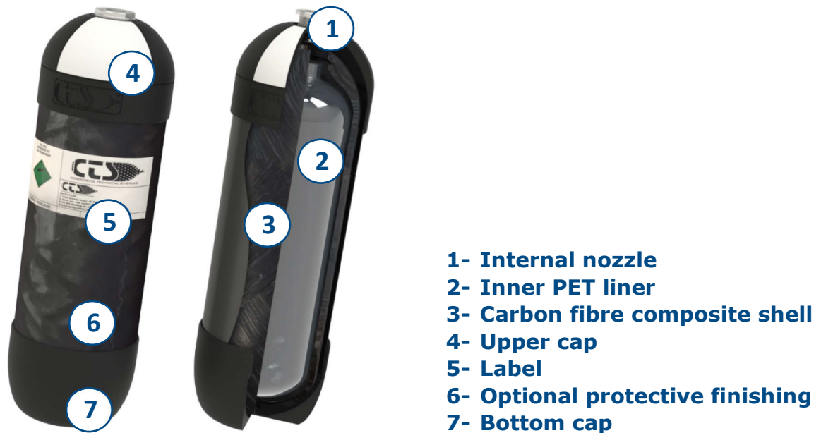
Afbeelding 1. Samenstelling van de cilinders van CTS
