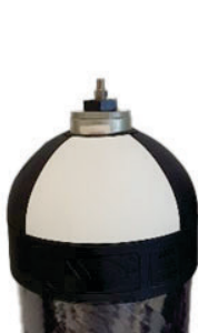
Afb. 4: Cilinder met afsluiter en 2 bar interne druk
