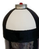
Sl. 6: Jeklenka s pokrovčkom in brez notranjega tlaka
