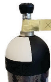
Sl. 7: Jeklenka z odprtim ventilom in trakom za zaščito pred odpiranjem
