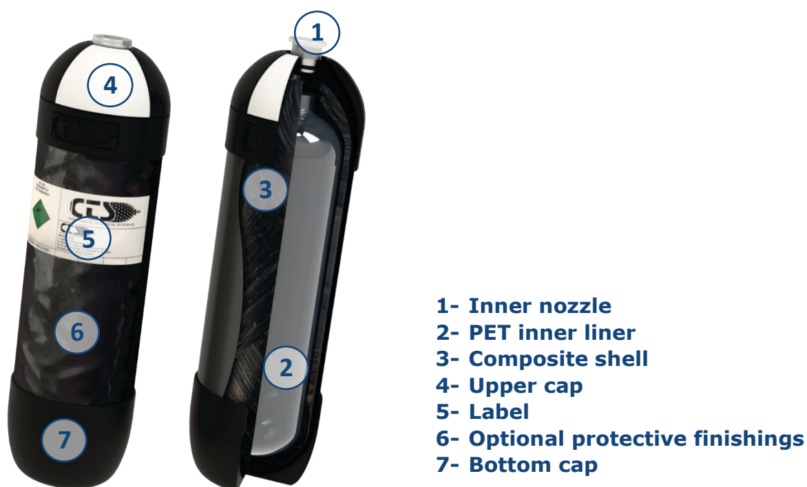
Figure 1. Schéma de composition de la bouteille de la CTS
