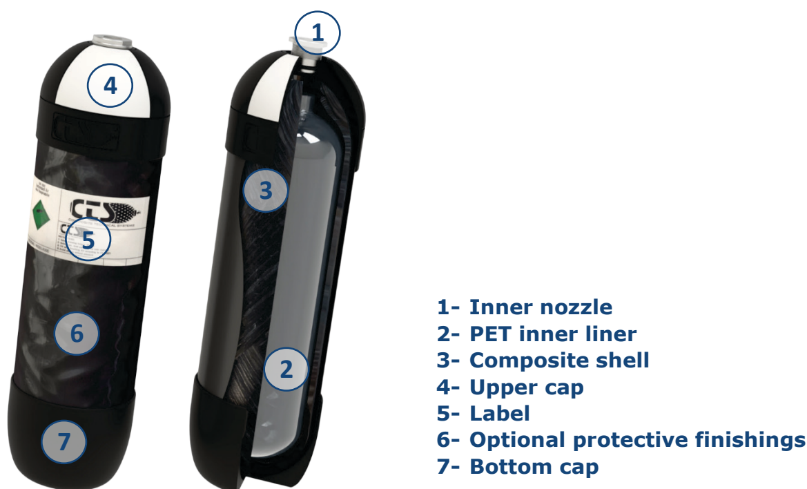
Figura 1. Esquema de composición del cilindro CTS
